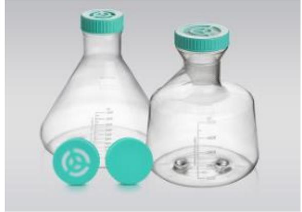
Колба Эрленмейера большой емкости в основном используется для крупномасштабного расширения и культивирования суспензионных клеток и бактерий и т. д., а также для приготовления, хранения и переноса жидкой питательной среды. Поскольку колба Эрленмейера большой емкости может значительно повысить эффективность культивирования, она широко используется в клеточной биологии, микробиологии и других областях.
