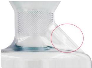
Уникальная конструкция сливной горловины 5-литровой колбы Эрленмейера предотвращает разбрызгивание жидкости при наливании.
